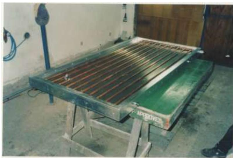
Slika 7. Konačna konstrukcija solarnog kolektora bez montiranog staklenog pokrova
