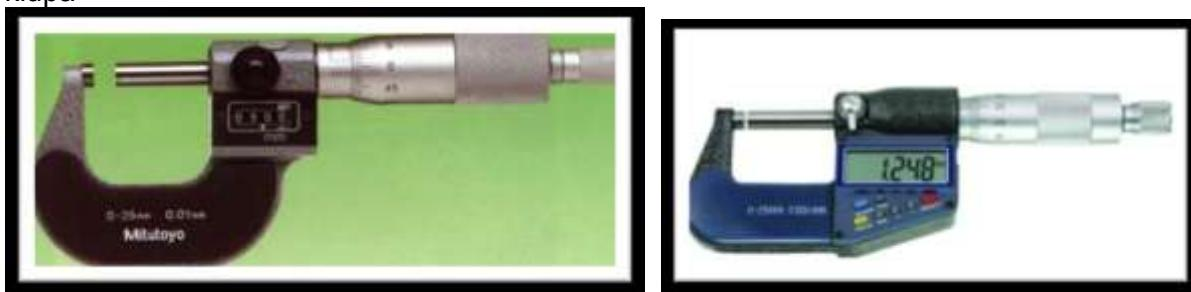
Slika 1.3.5. Mikrometar
