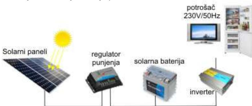
Slika 9. Solarni fotopaneli intergisani u sistem proizvodnje električne energije u domaćinstvu
