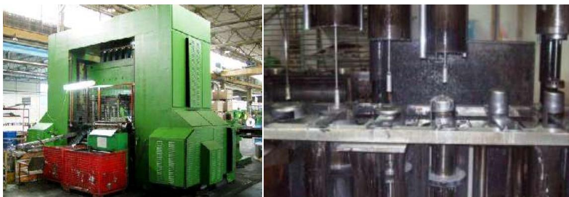
Slika 6. Izgled višepozicionne transfer prese sa primjerom rasporeda alata (Mann Hummel BA, Tešanj)
