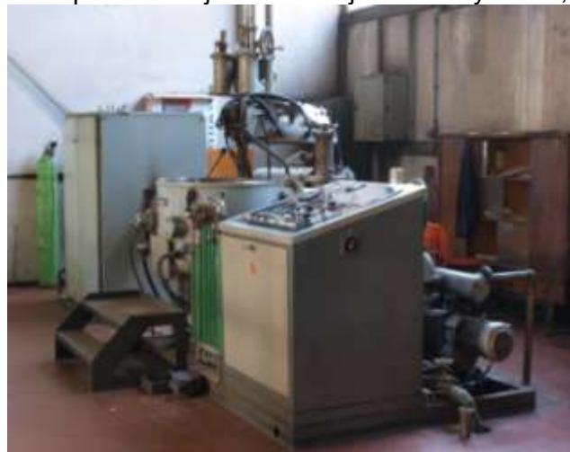
Slika 1. Fotografski snimak vakuumske peći
