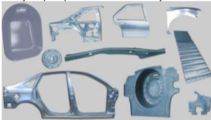
Slika 1. Limeni dijelovi automobila proizvedeni procesima prerade deformisanjem
